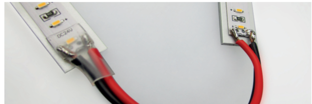
Abb. 3 Isolierung der Lötstellen: idealerweise mit einem Schrumpfschlauch
