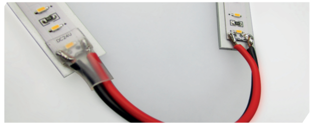
Fig 3 Isolation des points de soudure: idéalement avec une gaine thermorétractable
