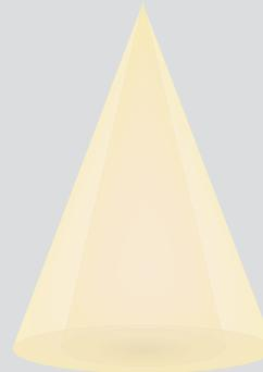
Angolo del fascio variabile: da 35° a 50° regolabile manualmente (con articolo n. 112574 e 112575)
