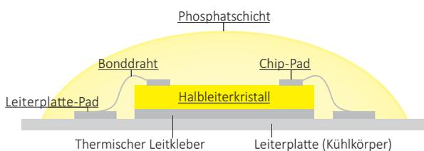
Questi LED tracklight AR111 sono basati sulla tecnologia sostenibile COB (chip on board). Il cristallo semiconduttore è direttamente collegato al circuito (substrato). I LED con COB non hanno perdite di potenza!
